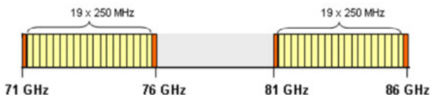
Figura 1: Provável arranjo básico das faixas em estudo em 38 blocos de 250 MHz e bandas de guarda. Os blocos podem ser reagrupados em números maiores ou menores de canais. (Relatório Anatel)
