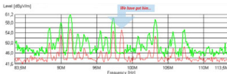
Imagem 15: No gráfico vermelho estão as intensidades de sinais monitoradas e em verde as máximas esperadas e configuradas pelo usuário. A partir do momento que um sinal ultrapassa o previsto, um alerta é enviado a todo sistema. (Foto: R&S Manual UMS100)
