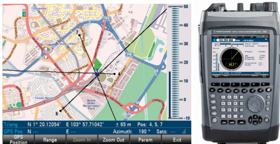
Imagens 3 e 4: Exemplo de equipamento portátil para DF, com captação entre 9 kHz e 7,5 GHz. O aparelho permite plotar digitalmente a localização da fonte interferente ao utilizar métodos de DF e interferometria com antenas dedicadas. (Foto: Manual R&S modelo DDF-007)
