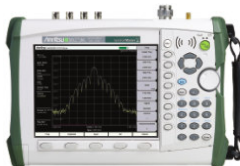
Imagens 11 e 12: Analisadores multifuncionais portáteis integrados a softwares de geoposicionamento também efetuam localizações por DF, como no caso destas imagens trabalhando entre 9 kHz e 43 GHz. (Fotos: Anritsu TV “Interference Mapping” e Manual Spectrum Master MS2726C)
