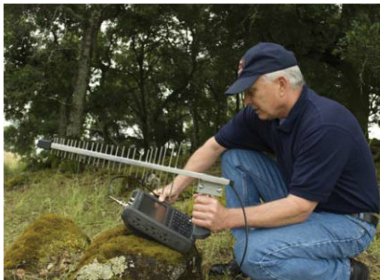
Imagens 1 e 2: Modernos receptores manuais multifuncionais permitem, acoplados a sistemas direcionais e softwares de geoposicionamento, a identificação e localização de fontes interferente. Nas imagens a atuação do receptor com capacidade de detecção entre 5 kHz e 9 GHz. (Fotos: Manual Agilent, modelo FieldFox N9912A)
