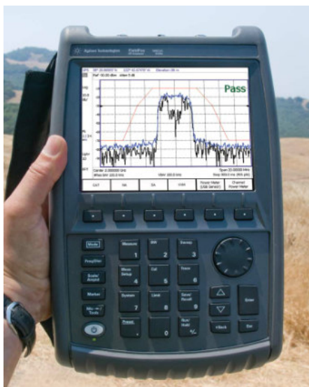
Imagens 1 e 2: Modernos receptores manuais multifuncionais permitem, acoplados a sistemas direcionais e softwares de geoposicionamento, a identificação e localização de fontes interferente. Nas imagens a atuação do receptor com capacidade de detecção entre 5 kHz e 9 GHz. (Fotos: Manual Agilent, modelo FieldFox N9912A)
